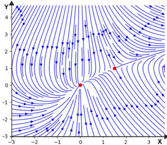
Figura 7.15: Diagrama fase del sistema  $\begin{cases} x' = xy - x \\ y' = 2x - 3y \end{cases}$ .
