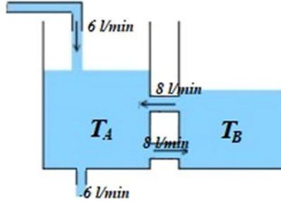
Figura 6.3: Sistema de tanques conectados  $T_A$  y  $T_B$ .
