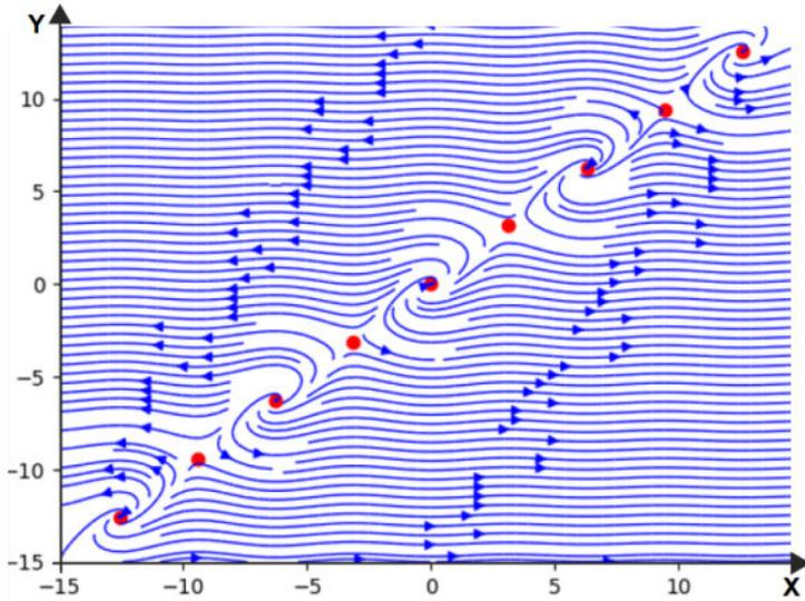
Figura 7.17: Diagrama de fase del sistema  $\begin{cases} x' = x - y \\ y' = \text{sen } x \end{cases}$
