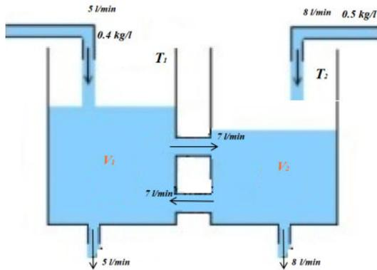
Figura 6.2: Sistema de tanques conectados  $T_1$  y  $T_2$ .
